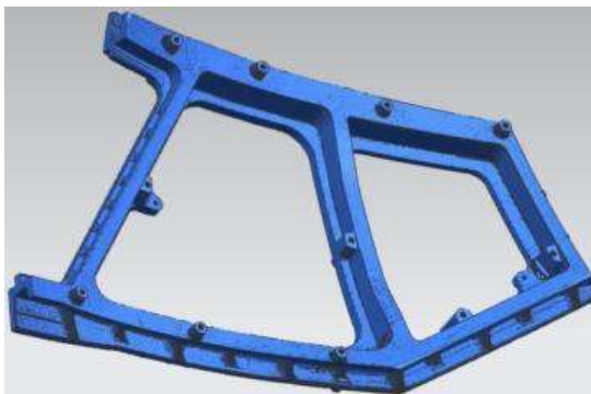
Рис. 4. 3D модель заготовки с равномерным припуском 6 мм
