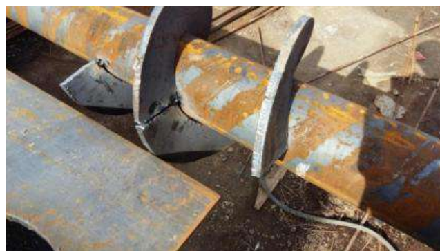
Рис. 3 – Дефекты шнека – разрывы
