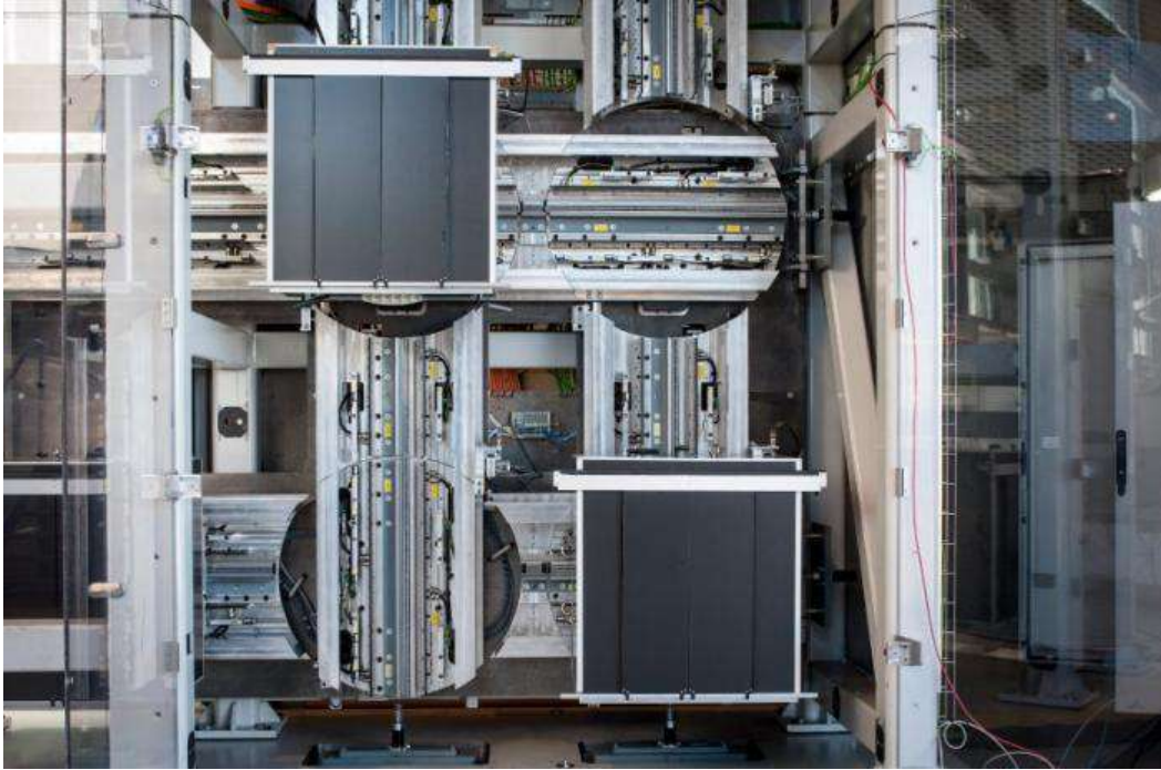
Рис. 1. Макет лифта с технологией линейного двигателя
