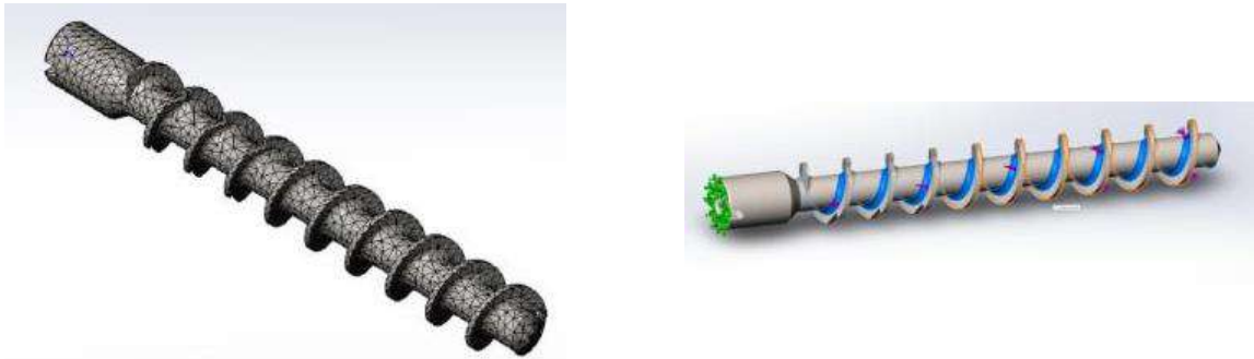
Рис. 4. Шнек. Разбиение шнека на сетку по методу конечных элементов с указанием силы действия на шнек. На выделенном участке действие силы в размере 5 000 Н.
