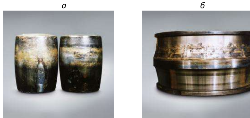
Рис.6. Дефект двухрядного подшипника:
