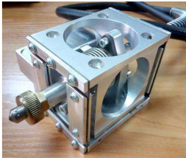
Рис. 5. Оправка для выглаживания пневматическая с ресивером (силовой элемент – сильфон со сжатым воздухом) с параллелограммной установкой индентора на 4-х плоских стойках
