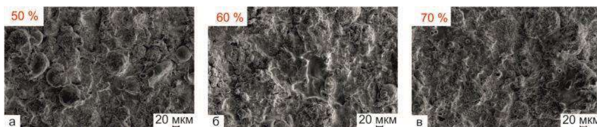
Рис. 2. Морфология поверхности детонационных покрытий \text{Fe}_{66}\text{Cr}_{10}\text{Nb}_5\text{V}_{19} .
