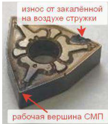
Рис. 2. Износ поверхности СМП от стружки
