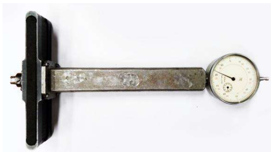
Рис. 1. Динамометрическая оправка с симметричной плоской пружиной для алмазного выглаживания (силовой элемент – плоская пружина)
