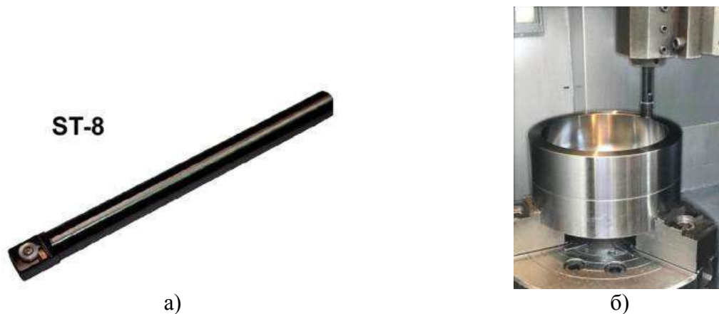
Рис. 4. Инструмент и пример отделочно-упрочняющей обработки внутренней поверхности
