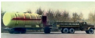
Рис.2 Автоцистерна ТРЖВ-20 на шасси автомобильного прицепа.
