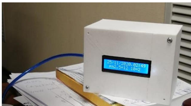
Рис. 2. Внешний вид прибора мониторинга атмосферного воздуха
