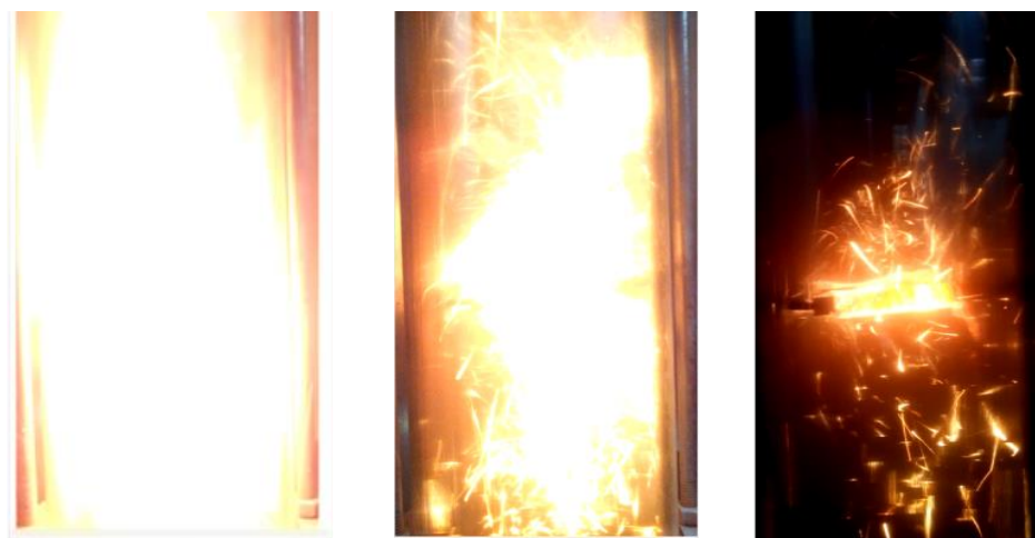
Рис.1. Горение порошка наножелеза а) начало горения б) горение через 0,077 с в) завершение горения 0,154 с
