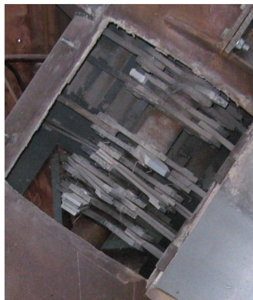
Рис. 2. Рабочее оборудование дробилки с наклонным корпусом
