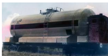
Рис. 3 Железнодорожная цистерна 8Г514 для транспортировки жидкого водорода.
