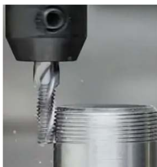
Рис. 1. Фрезерование резьбы с постоянным шагом на цилиндрической поверхности
