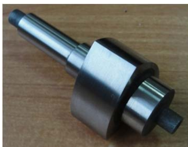
Рис. 3. Деталь в форме РК-профиля, полученная методом фрезоточения
