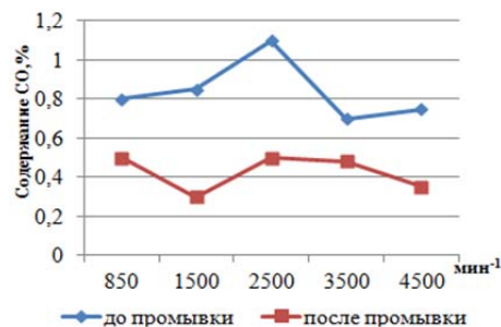
Рис. 2. Содержание СО в ОГ до и после промывки системы впрыска
