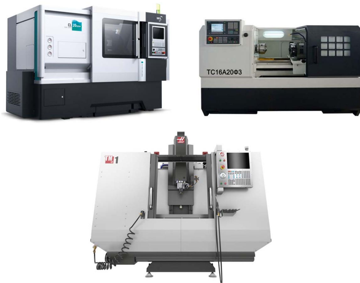
Рис. 1. Станок со стационарной высотой расположения монитора. Высота станка 1760 мм, 1500 мм и 2667 мм соответственно
