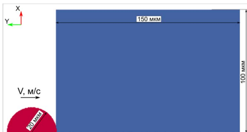
Рис. 1. Схема постановки задачи столкновения сферической частицы с подложкой
