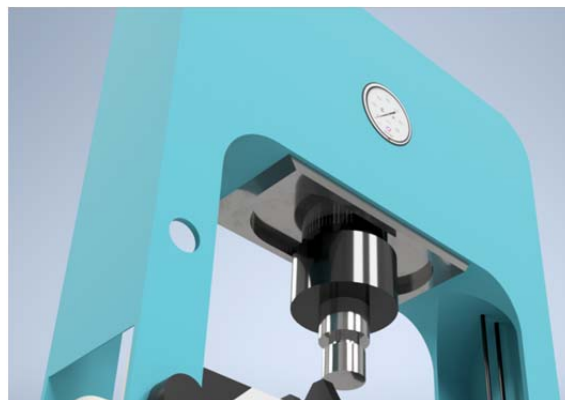
Рис. 3. Положение манометра и ход штока гидравлического пресса
