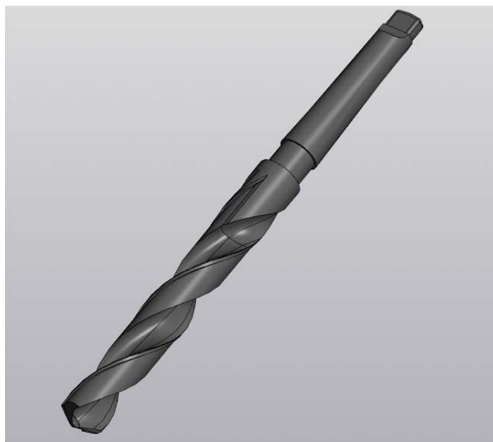
Рис. 3. Твердотельная модель сверла 2301-0069 ГОСТ 10903-77
