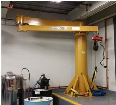
Рис. 6. Консольный поворотный кран со складывающейся стрелой [3]
