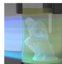
Рис. 7. Объект, сформированный CAL технологией
