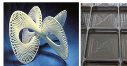
Рис. 8. Ажурное маложёсткое изделие, изготовленное АТ (а) и решётка (б)
