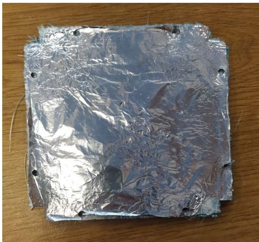
Рис. 1. Экранно-вакуумная изоляция стратосферного спутника
